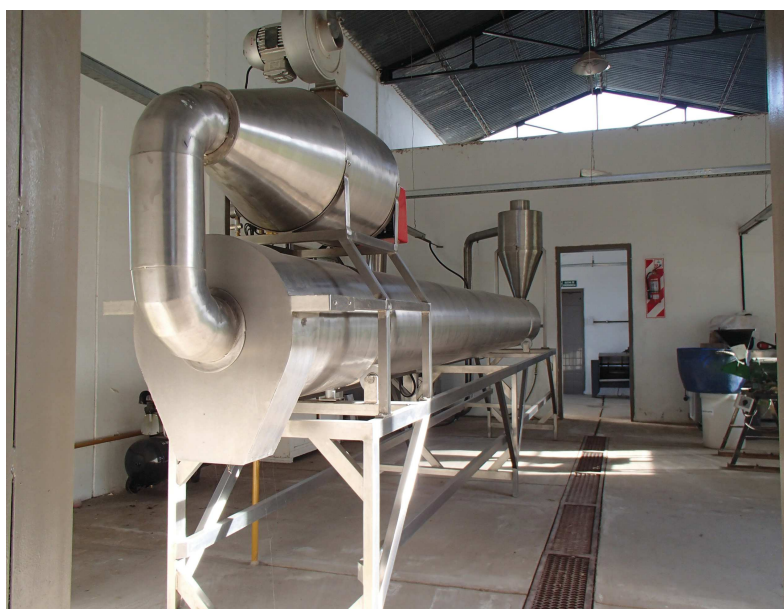
Foto 1: Extrusora en sala de fabricación de alimento en el CENADAC Fuente: G.Dapello - Dirección Nacional de Acuicultura
